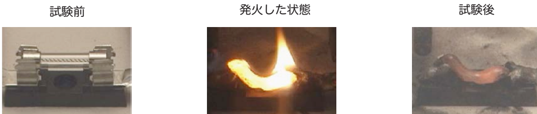
定格電圧より高い電圧での遮断試験例
